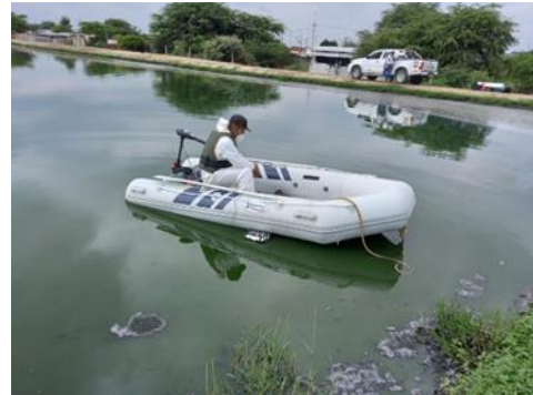
Imagen N°11: Trabajos de batimetría con ECOSONDA
