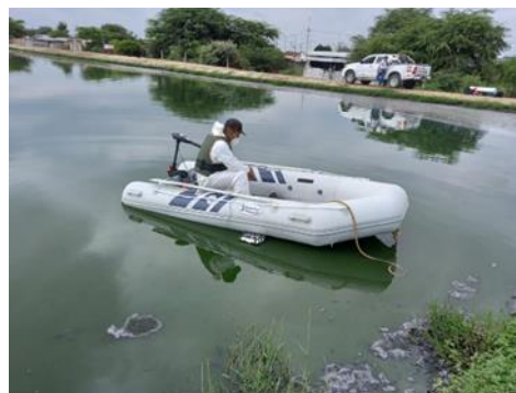
Imagen N°11: Trabajos de batimetría con ECOSONDA
